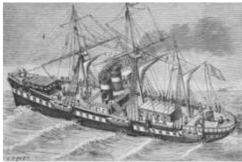
PONT SUPÉRIEUR D'UN PAQUEBOT A VAPEUR.—A droite, se trouve la roue à l'aide de laquelle on manie le gouvernail. Près de là, on voit les cabines du capitaine et des officiers. A gauche, sont les cages des animaux. Les passagers logent au-dessous, à l'étage plus bas: les petits trous que l'on voit le long du vaisseau sont les fenêtres de leurs cabines.
